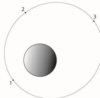
Решение. а) Единственная сила, действующая на спутник - сила притяжения Земли. Поэтому векторы ускорений во всех точках орбиты направлены к центру Земли (а не к центру эллипса).
